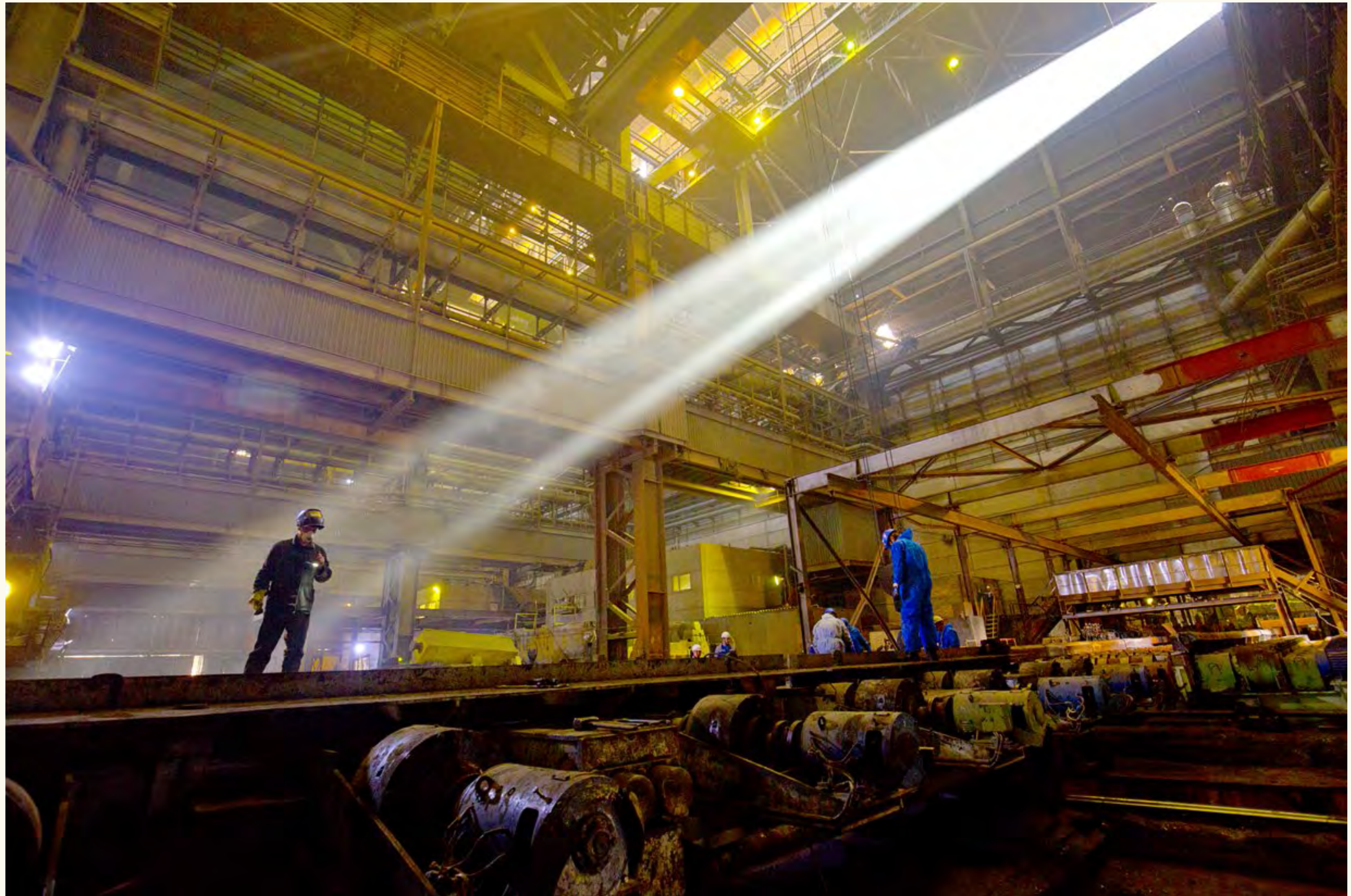
Mitarbeiter der SMS group warten eine der sechs Stranggießanlagen von MMK in Magnitogorsk. | Сотрудники SMS group проводят техобслуживание одной из шести машин непрерывного литья заготовок на MMK в Магнитогорске.
