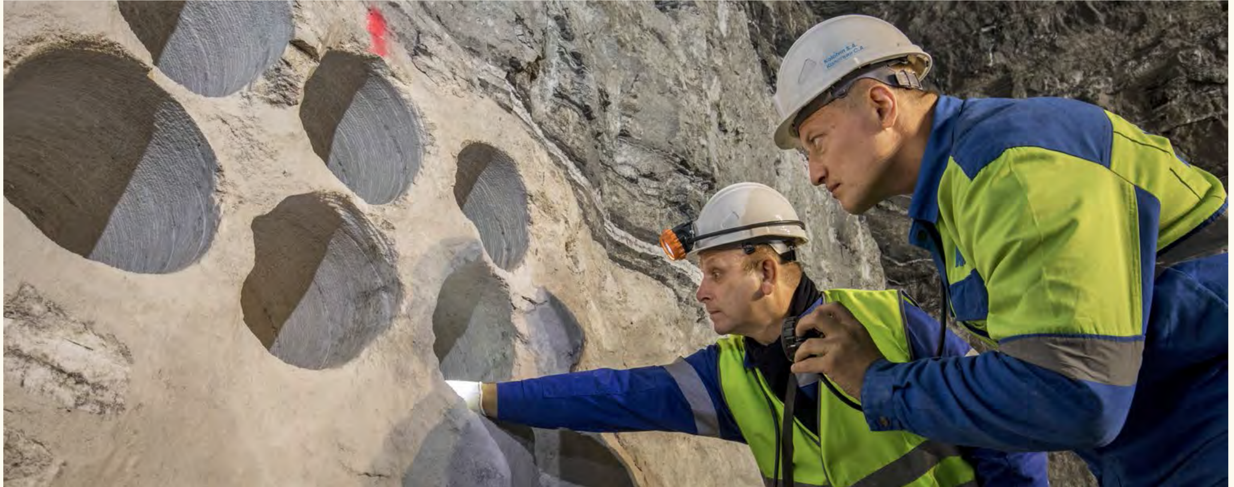
In Nowomoskowsk betreibt Knauf die größte Gips-Grube Europas. Der graue Rohstoff wird durch Sprengung vom Felsen gelöst. | В Новомосковске в распоряжении КНАУФ находится самое большое гипсовое месторождение Европы. Скалу взрывают, отделяя от нее таким образом гипс.
