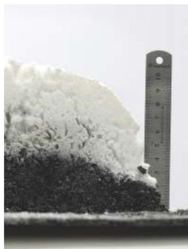
Теплоизолирующий слой огнезащитного покрытия ПЛАМКОР, вспучившийся под воздействием высоких температур
