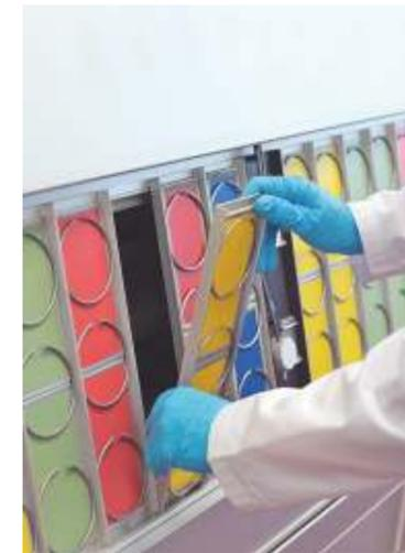
Испытания на светостойкость в везерметре
