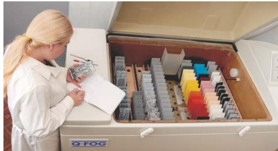
Коррозионные испытания в камере соляного тумана
