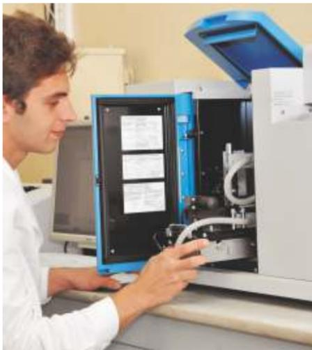
Исследование дисперсности металлических порошков на лазерном анализаторе
