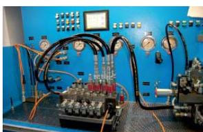
Для улучшения качества обслуживания и оказания технической поддержки компания Гидронт организовала сервисный центр для испытания гидравлических распределителей, клапанов, блоков клапанов любых производителей, который позволяет нашим заказчикам проводить диагностику гидроаппаратуры для выявления неисправности либо соответствия заявленным характеристикам.
