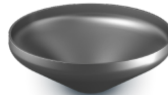
Днища конические отбортованные \varnothing — 800 \div 4200 мм s — 4 \div 22 мм
